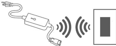
Ces derniers ressemblent aux modèles traditionnels et s'installent facilement sur une surface intérieure ou dans une boîte murale existante sans requérir de câblage. Jusqu'à trois interrupteurs complémentaires peuvent être associés à un D2150.
