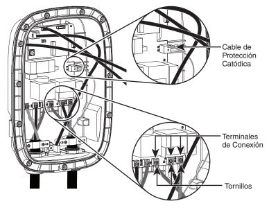
Apriete los dos tornillos que fijan la placa de sujeción.
