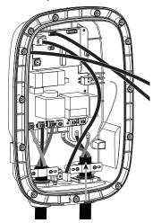
Conecte el cable de protección catódica a la placa de circuito. Instale las terminales de conexión del cable en la placa de circuito con tres tornillos. Apriete los tornillos a 8.5 - 10.5 pulg-lb.
