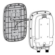
Retire los tres tornillos y las terminales de conexión del cable de la placa del circuito. Desconecte el cable de protección catódica.
