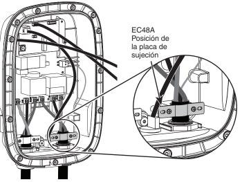
Instale la tapa delantera en la tapa trasera y fíjela con 13 tornillos. Apriete los tornillos a 8.5 - 10.5 pulg-lb.
