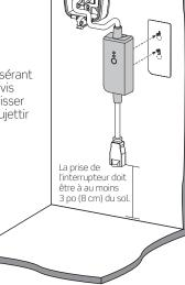
**REMARQUE:** on peut retirer l'interrupteur du mur en le soulevant délicatement des vis.
