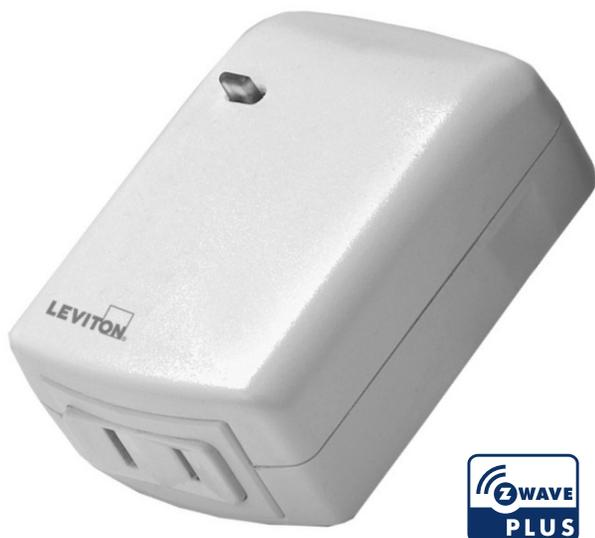
Les gradateurs enfichables DZPD3 à technologie Z-Wave sont tout indiqués pour assurer le tamisage et l'intensification à distance de charges à incandescence (jusqu'à 300 W) ou à DEL/fluocompactes (jusqu'à 100 W). Grâce à eux, on peut commander des lampes sur pied individuellement ou comme composants d'ambiances ou de zones programmées au moyen d'un contrôleur Z-Wave compatible.
